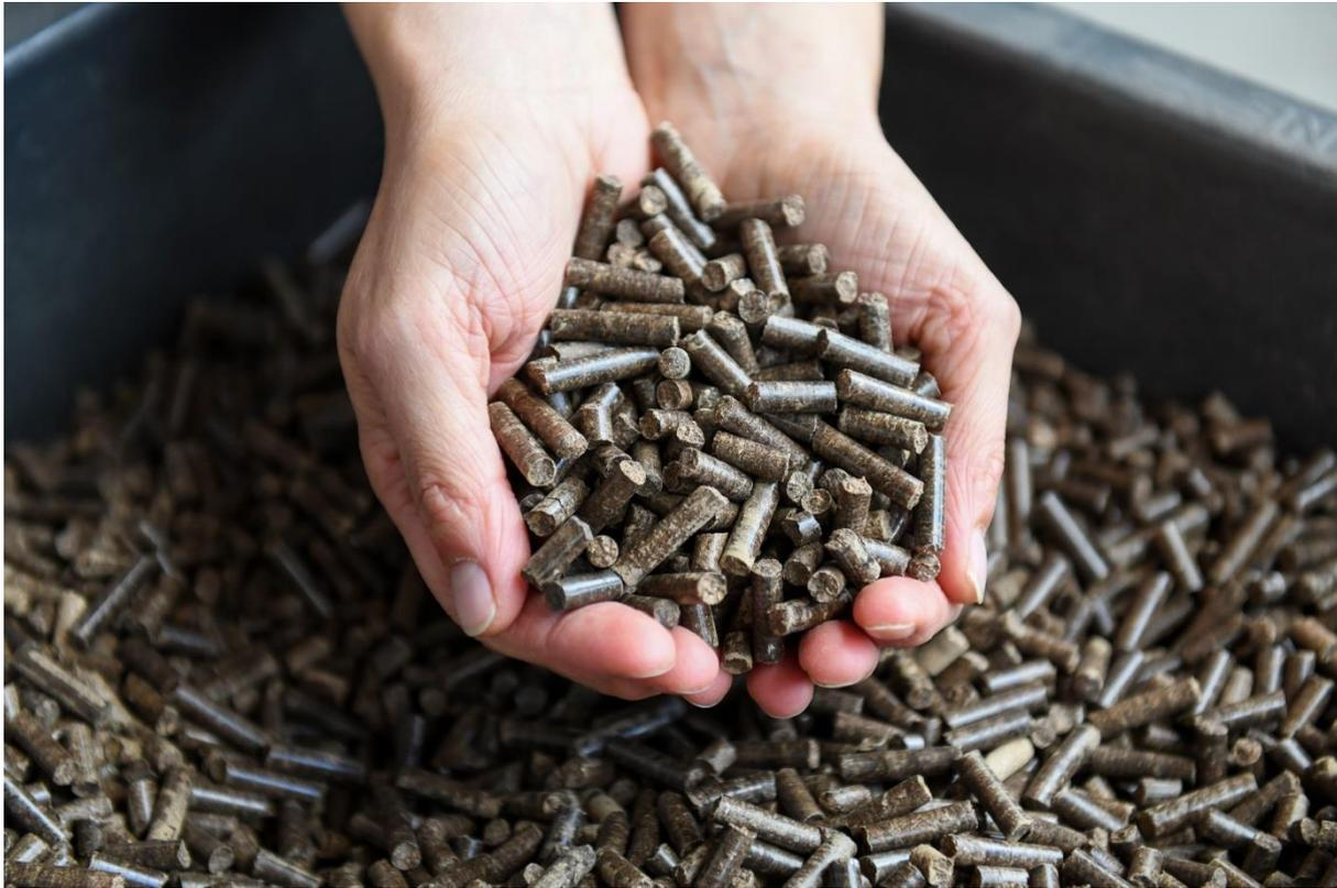
Abbildung 4: Seggenpellets (*Carex ssp.*) mit 1,5 m-% Kaolin, produziert mit der Pelletieranlage des TFZ
