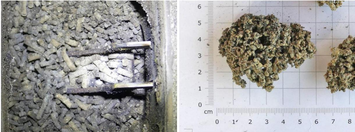
Abbildung 46: Schlackepartikel nach der Verbrennung von *Typha ssp.* auf dem Rost von Biomassekessel 2 (links) und Schlackebrocken aus *Phalaris arundinacea* aus demselben Kessel (rechts)
