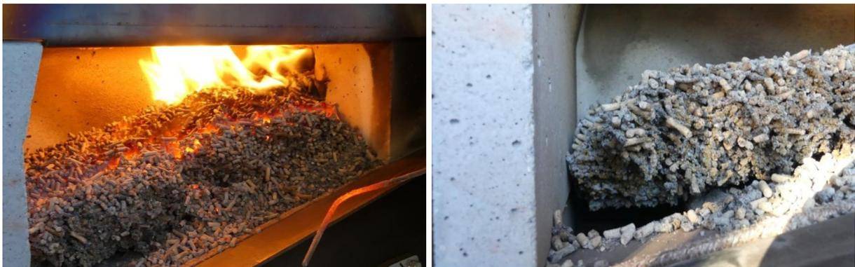
Abbildung 41: Teilweise verschlackte Pellets aus *Phalaris arundinacea* auf dem Treppenrost von Kessel 1 während der Verbrennung (links) und nach der Abkühlung (rechts)
