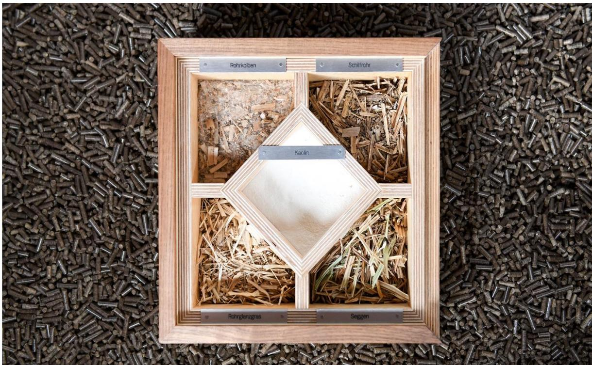
Abbildung 1: Paludibrennstoffe (Häckselgut) aus der Ernte vom Februar 2018 und das im Projekt verwendete Additiv: Rohrkolben (*Typha ssp.*, oben links); Schilfrohr (*Phragmites australis*, oben rechts); Rohrglanzgras (*Phalaris arundinacea*, unten links); Seggen (*Carex ssp.*, unten rechts); Kaolin (Mitte)
