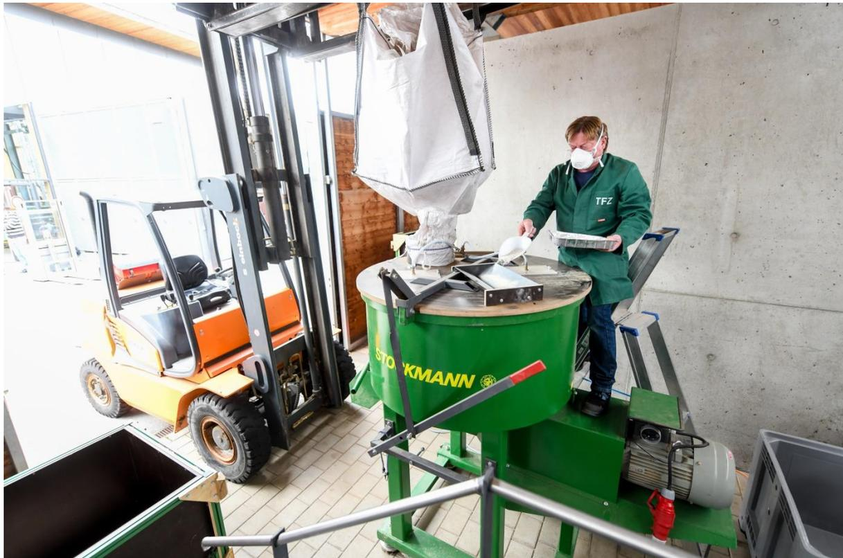
Abbildung 3: Konditionierung gemahlener Paludibrennstoffe mit Kaolin im Futtermittelmischer (Stockmann Landtechnik GmbH, Typ 500 ESK)
